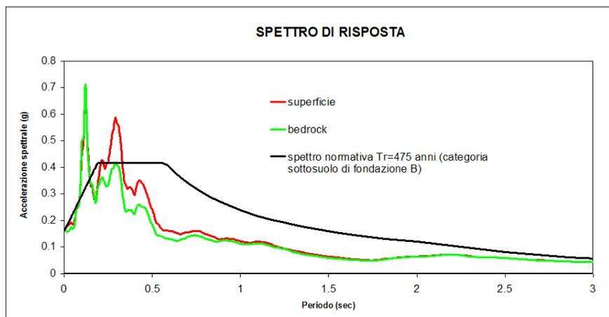
Fig. c - spettro di risposta relativo alla PSA confrontato con lo spettro di normativa
