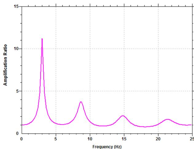
Fig. d - spettro di amplificazione del sisma lungo tutta la colonna litologica
